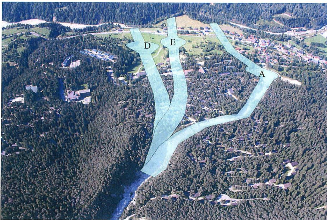
Fig. 13. Prospettiva dall'apice della conoide e sezioni di ingombro delle soluzioni analizzate
